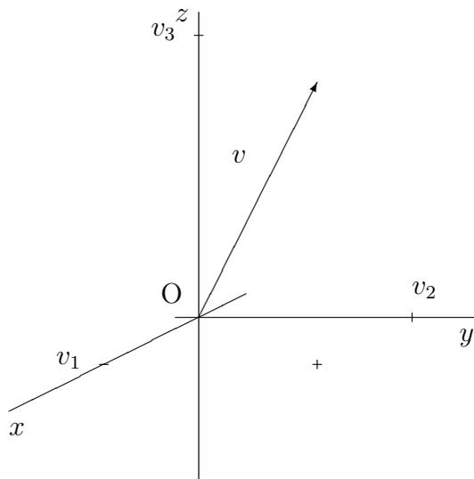
Ora, un punto che partendo da  $O$  si sposta prima nel punto di coordinate  $(v_1, v_2, 0)$  e poi si sposta di  $v_3$  unita' nella direzione dell'asse  $z$ , descrive i due cateti di un triangolo rettangolo che ammette  $v$  come ipotenusa.
