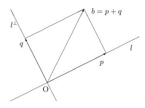
Vediamo ora come questa costruzione si possa effettuare algebricamente. Fissiamo nel piano un sistema di riferimento cartesiano ortogonale monometrico con origine nel punto O, ed identifichiamo i vettori di  $\mathbb{R}^2$  con vettori applicati in O. Possiamo allora descrivere la retta l come l'insieme dei vettori multipli scalari di un vettore non nullo a:
