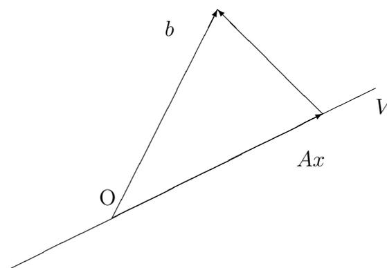
Ora, il vettore  $Ax^*$  ha, fra i vettori di  $V$ , distanza minima dal vettore  $b$  se e solo se il vettore  $Ax^*$  e' la proiezione ortogonale  $p$  del vettore  $b$  su  $V$ .
