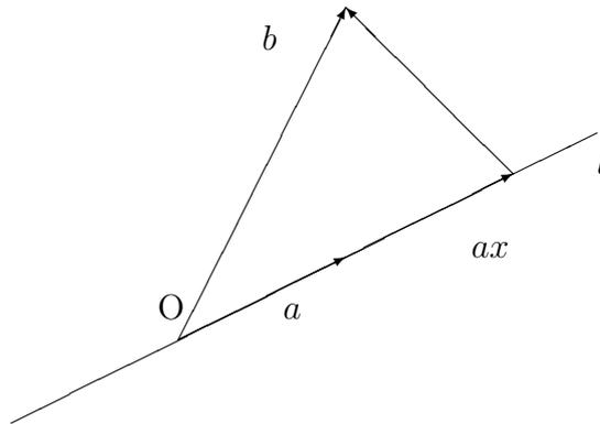
Ora, il vettore  $ax^*$  ha, fra i vettori della retta generata da  $a$ , distanza minima dal vettore  $b$  se e solo se il vettore  $ax^*$  e' la proiezione ortogonale  $p$  del vettore  $b$  sulla retta generata da  $a$ .
