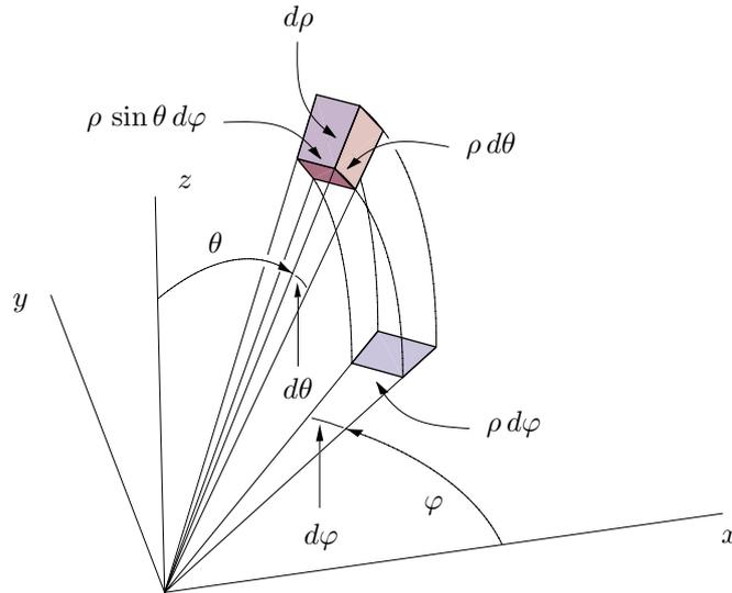
Figura 7.12. L'elemento di volume in coordinate sferiche si scrive  $\rho^2 \sin \theta d\rho d\theta d\varphi$ .
