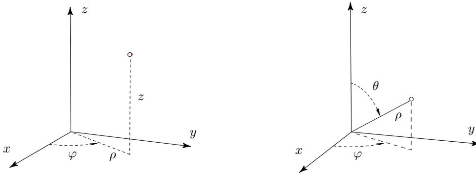
Figura 7.11. Coordinate cilindriche (a sinistra) e coordinate sferiche (a destra).
