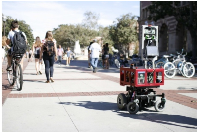
Figura 3.21: Robot che esegue navigazione autonoma in un ambiente esterno non vincolato (campus universitario) e tra le persone. Il robot deve risolvere due sotto-problemi: stimare la direzione di strada e evitare ostacoli
