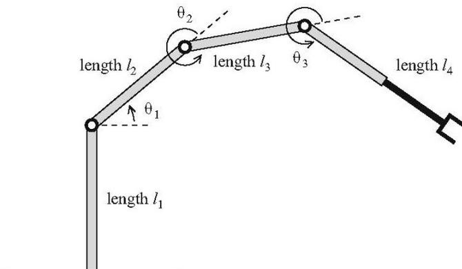
Siano  $(a, b)$  le coordinate (nel sistema fissato con l'origine nel giunto 1 con l'asse  $x_1$  orizzontale a destra e l'asse  $y_1$  verticale in alto) del punto in cui si trova la mano. L'orientamento della mano sia dato dall'angolo  $\alpha$  (che si misura come  $\theta_1$  in senso antiorario partendo dall'asse  $x_1$ ).
