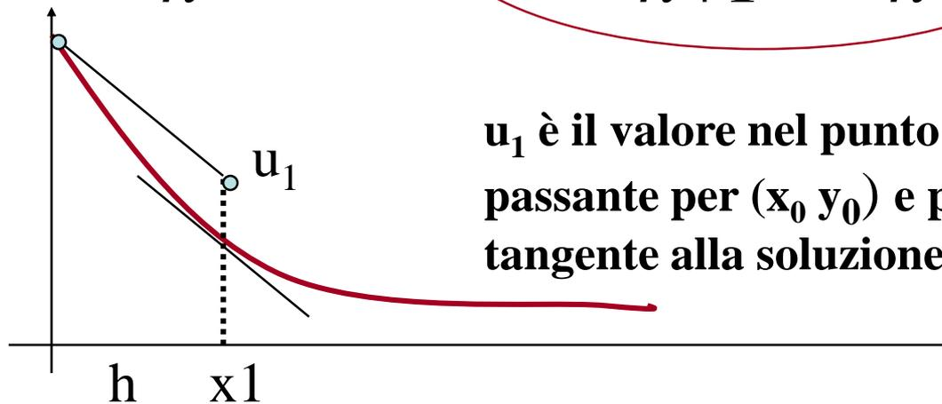
$u_1$  è il valore nel punto  $x_1$  della retta passante per  $(x_0, y_0)$  e parallela alla tangente alla soluzione nel punto  $x_1$ .
