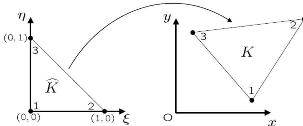
Figura 1: Trasformazione di coordinate da  $\widehat{K}$  al generico triangolo  $K \in \mathcal{T}_h$ .
