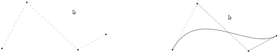
Figure 1: Sulla sinistra il poligono di controllo disegnato tramite l'applicazione ConnectDots. Sulla destra la curva di Bézier ottenibile dopo aver sviluppato i punti (d) od (e)
